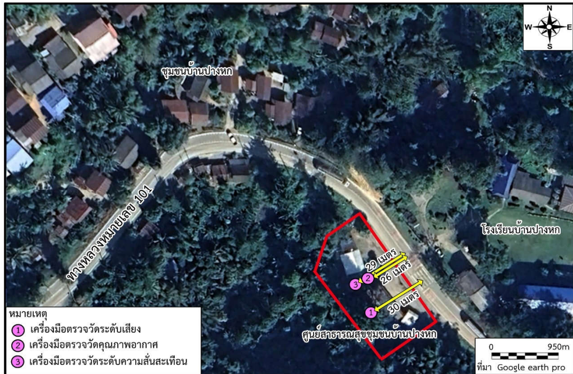
รูปที่ 5.2.3-4 สถานีติดตามตรวจสอบคุณภาพอากาศ ระดับเสียง และความสั่นสะเทือน บริเวณหมู่ที่ 5 บ้านปางหก
